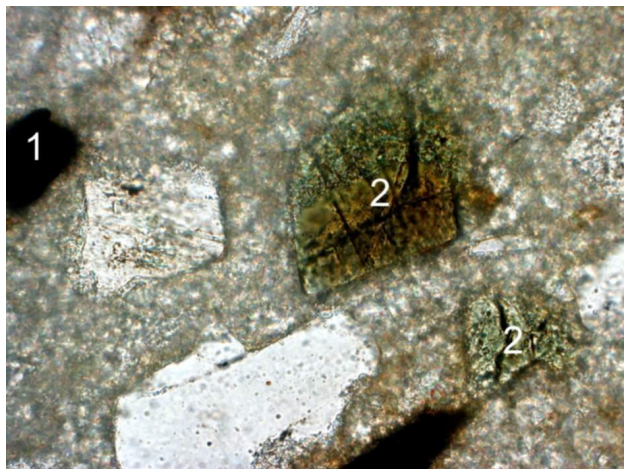
Obr. 6 Organodetritický vápenec s klastami (1) spinelu, (2) turmalínu kreme a albitu.
