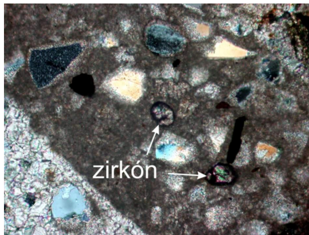
Obr. 4 Organodetritický vápenec s oválnymi klastami zirkónu a s ostrohrannými klastami kreme a a albitu.
