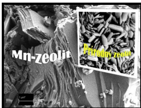
Obr. 5 Snímky prírodného a Mn-zeolitu (elektrónový rastrovací mikroskop SEM).
