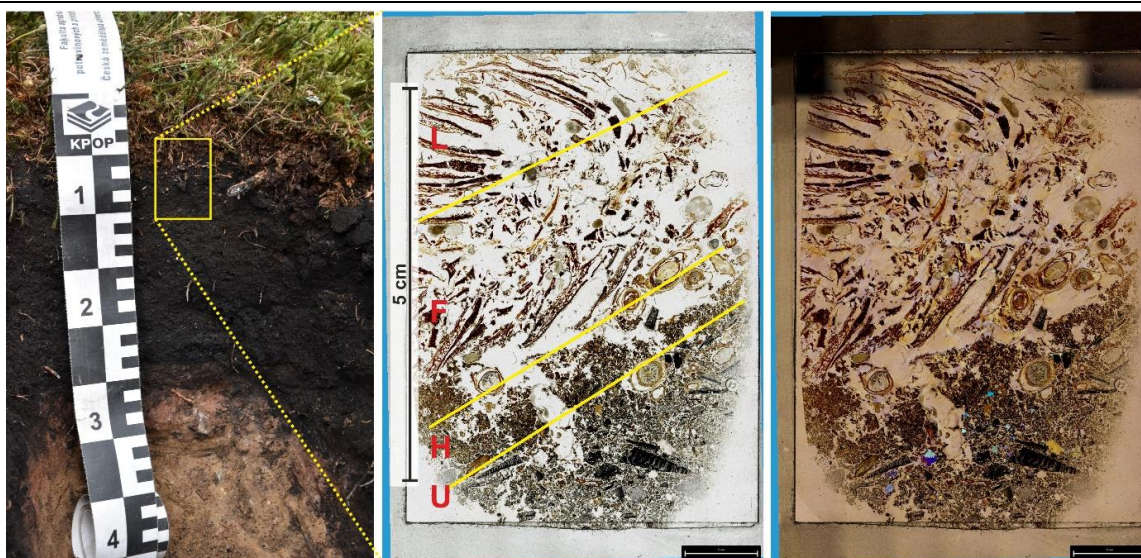
Obr. 2 Přejít organických horizontů (opad, dřev a měl – L, F, H) a antropogenního uhelného (U) horizontu v procházejícím světle (PPL, uprostřed) a se zkříženými nikoly (XPL, vpravo) na milířišti v Českém lese.
