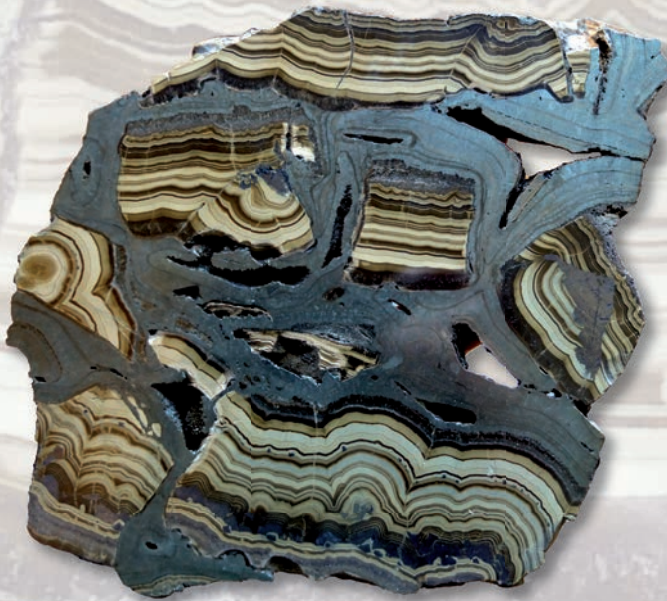
Brekcie páskovaných fragmentov so sfaleritom a galenitom, tmelené markazitom. Ložisko MVT, Pomorzany, Poľsko. Vzorku poskytol Adam Piestrzyński. (foto: J. Majzlan)
