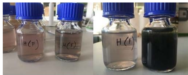
Obr. 1: Prídavok železnej soli pred úpravou pH=3,5 (vľavo) po úprave pH=7-8 (vpravo).
