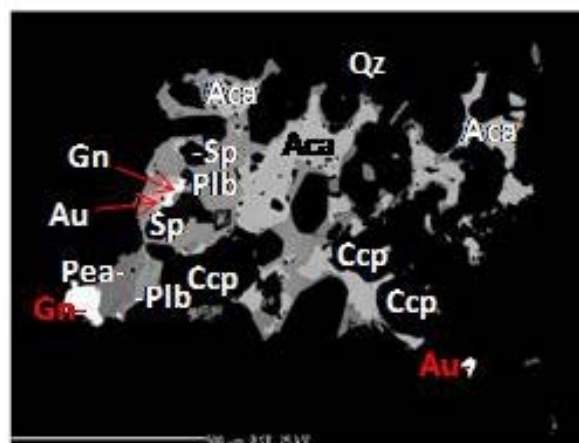
Obr. 2: (BSE) Au-Ag zrudnenie reprezentované polybazitom (Plb), pearceitom (Pea), akantitom (Aca), galenitom (Gn), sfaleritom (Sp), chalkopyritom (Ccp) a zlatom (Au) v žilnom kremeňi.
