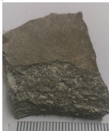
Obr. 1: Kúsok strešnej krytiny – eternitu na lome
