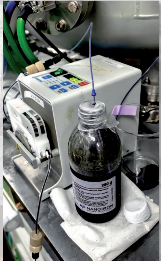
Analýza reaktívnej suspenzie nanoželeza (foto: M. Vítková)
