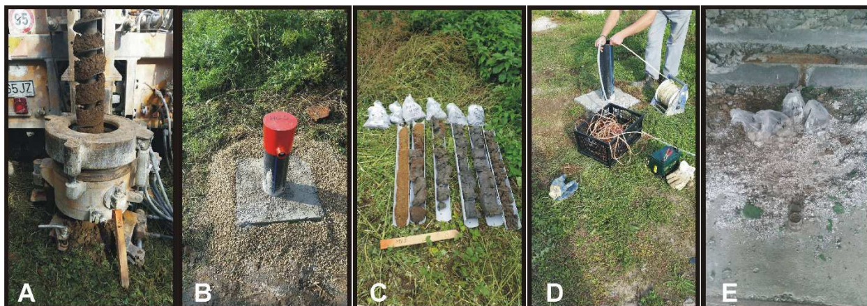
Obr. 2 Geologické práce na vybranej lokalite - Rykynčice. A) vrtné práce, B) zabudovaný hydrogeologický monitorovací vrt; C) odber pôdnych vzoriek, D) odber vzoriek podzemných vôd z hydrogeologického vrtu, E) odber vzoriek betónových konštrukcií zo skladu pesticídov
