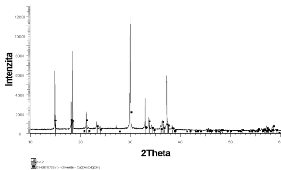
Obr. 6: Rtg difrakčný záznam Olivenitu \text{Cu}_2\text{AsO}_4(\text{OH}) pred lúhovaním
